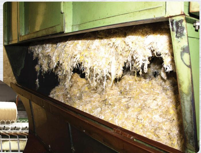
Maschine zum Öffnen von Fasern
